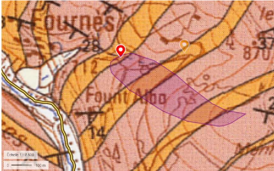
Figure 10 : Aire d'alimentation supposée de la source Peyris
